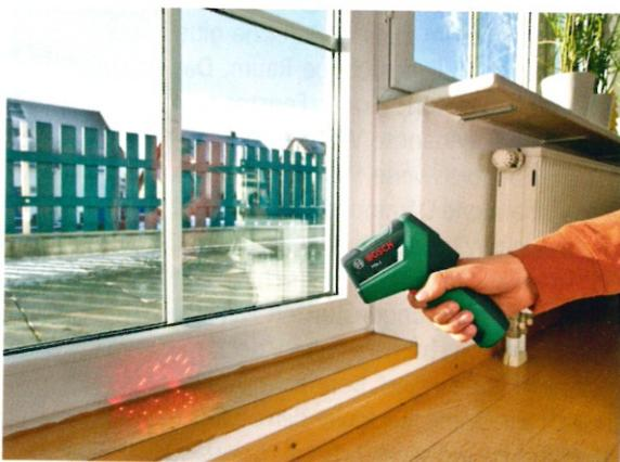
Kalte Stellen begünstigen die Kondensation. Mit einem Thermodetektor kommt man diesen Stellen noch besser auf die Spur. Bosch Elektrowerkzeug
