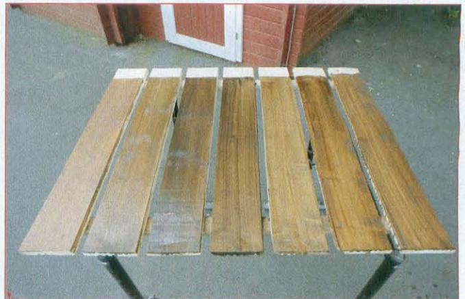
Nach dem zweiten Durchgang trocknen alle Hölzer etwa 16 Stunden, bevor die Belastungstests durchgeführt werden
